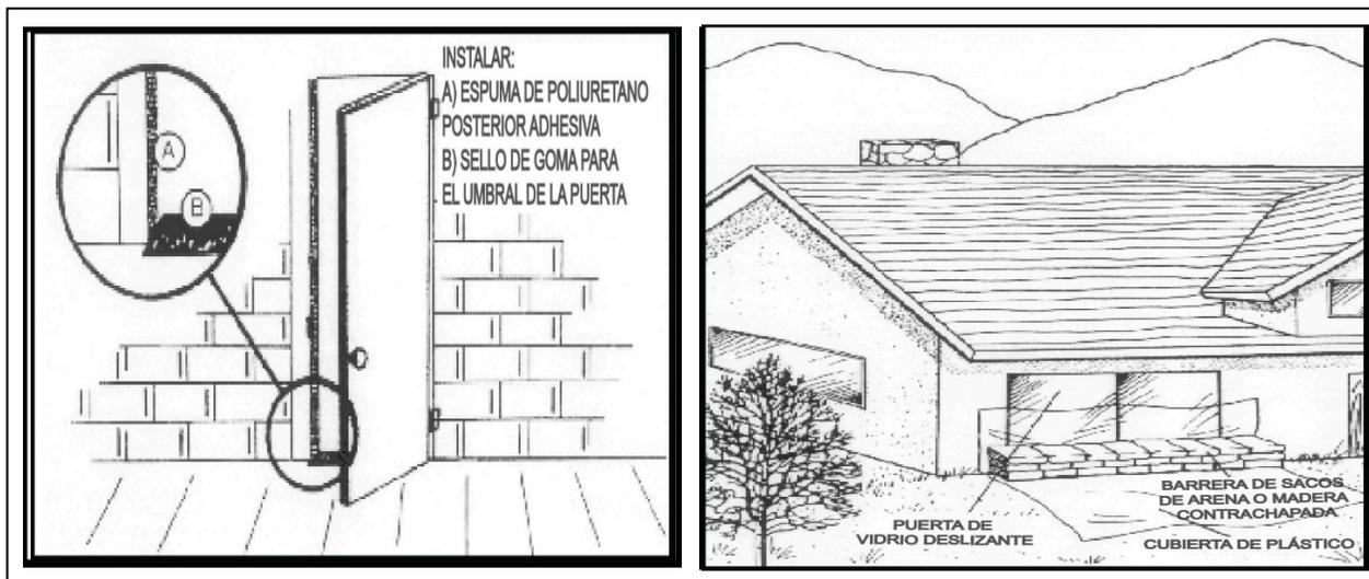
**Figura 5: sellado de puertas convencionales y puertas de vidrio deslizantes**
